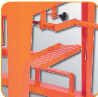
Schneidkopf wird durch Fußpedal und Handhebel (ISM) bedient.
