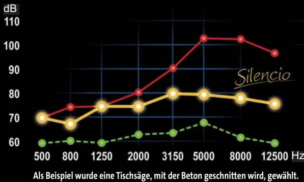
Durch neue Technologien erreicht die laser-geschweißte NORTON SILENCIO eine noch nie dagewesene Lärmreduktion von bis zu 15 dB (A). Die zum Patent angemeldete Stahlkernkonfiguration ermöglicht erstmalig eine deutliche Senkung der für das menschliche Ohr äußerst unangenehmen Schallfrequenzen (Pfeifeffekte), die beim Einsatz herkömmlicher Diamantscheiben entstehen.
